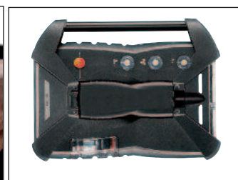
Для безопасности при транспортировке управляющий модуль устанавливается в блок анализатора обратной стороной
