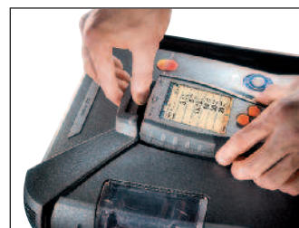
Управляющий модуль просто "защелкивается" в блок анализатора
