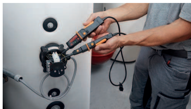
Измерение напряжения на бойлере
