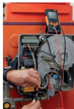
Подготовка к измерению ионизационного тока
