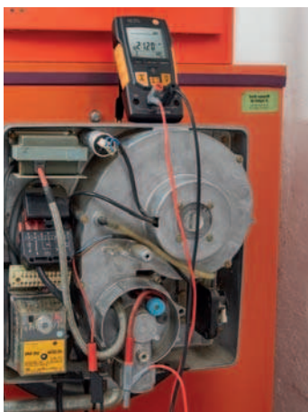
Измерение потока ионизации с testo 760
