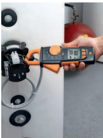
Измерение напряжения на бойлере с testo 770
