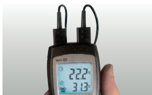
Одновременная регистрация температурных значений с двух подсоединенных зондов и отображение дифференциальной температуры
