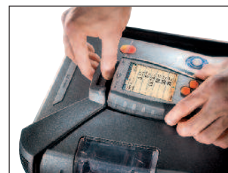
Управляющий модуль просто "защелкивается" в блок анализатора
