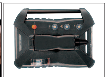
Для безопасности при транспортировке управляющий модуль устанавливается в блок анализатора обратной стороной
