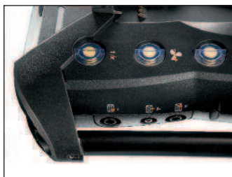
Быстрая замена фильтров без дополнительных инструментов
