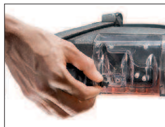
Режим непрерывной откачки конденсата для продолжительных измерений
