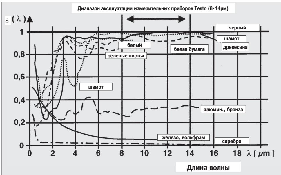
Коэффициент излучения разных водонепроницаемых материалов зависит от длины волны
