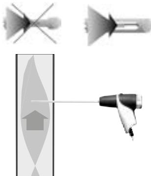
Поток газов должен беспрепятственно попадать на термопару через отверстия в зонде.
